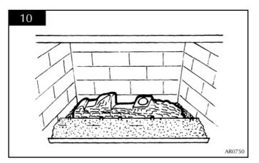
CENTRALISE THE LOG BETWEEN THE BURNER PORTS AT EITHER END.
