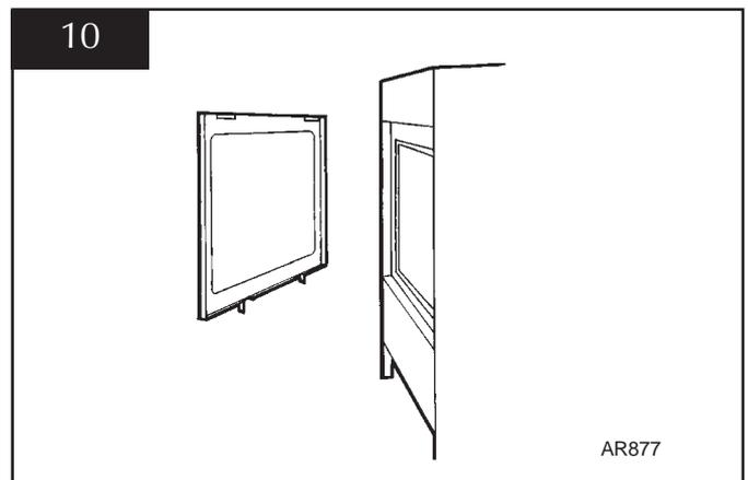
**NEVER OPERATE THE STOVE WHEN THE DOOR IS REMOVED**
