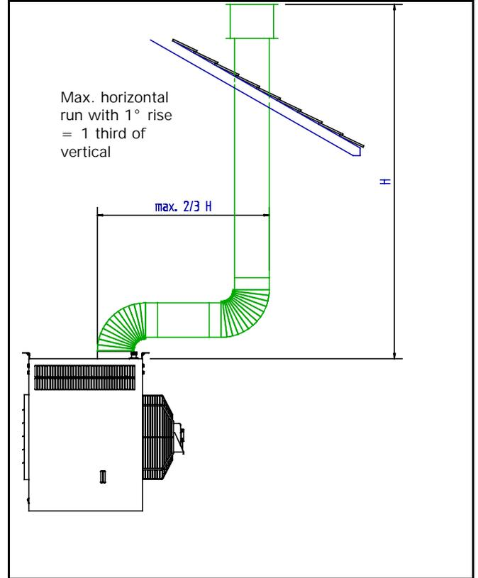
**Figure 6. COMMON FLUE SYSTEMS**
